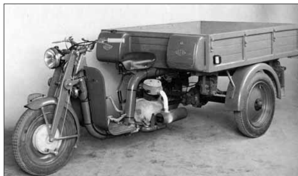
Le tricycle Gilera 150 de 1952 avec le moteur disposé transversalement pour éviter un engrenage conique.
