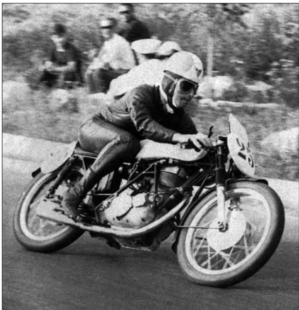
Osvaldo Perfetti avec une Bianchi 220 spéciale à cadre treillis utilisée en compétition sur circuit en 1957-58.
