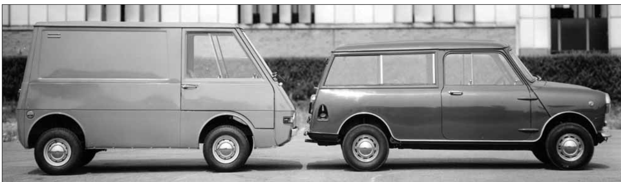
Le prototype d'une fourgonnette de 400 kg, également construit en collaboration avec Carrozzeria Boneschi en 1968. Le moteur, conçu par Innocenti, était un bicylindre de 500 cm 3 d'une puissance de 28 ch à 5 500 tr/min.
