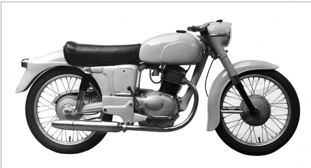
Le premier prototype de la Bianchi Bernina 125, avec un châssis abandonné ultérieurement pour des raisons de coût.
