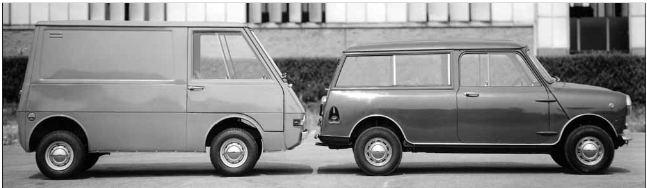
Le prototype d'une fourgonnette de 400 kg, également construit en collaboration avec Carrozzeria Boneschi en 1968. Le moteur, conçu par Innocenti, était un bicylindre de 500 cm 3 d'une puissance de 28 ch à 5 500 tr/min.
