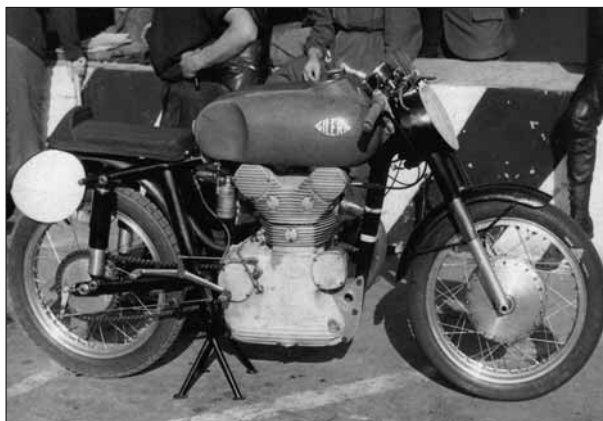
Le moteur Gilera 500 à double arbre à cames en tête, conçu en 1950-51, construit en 1952 puis abandonné faute de temps.
