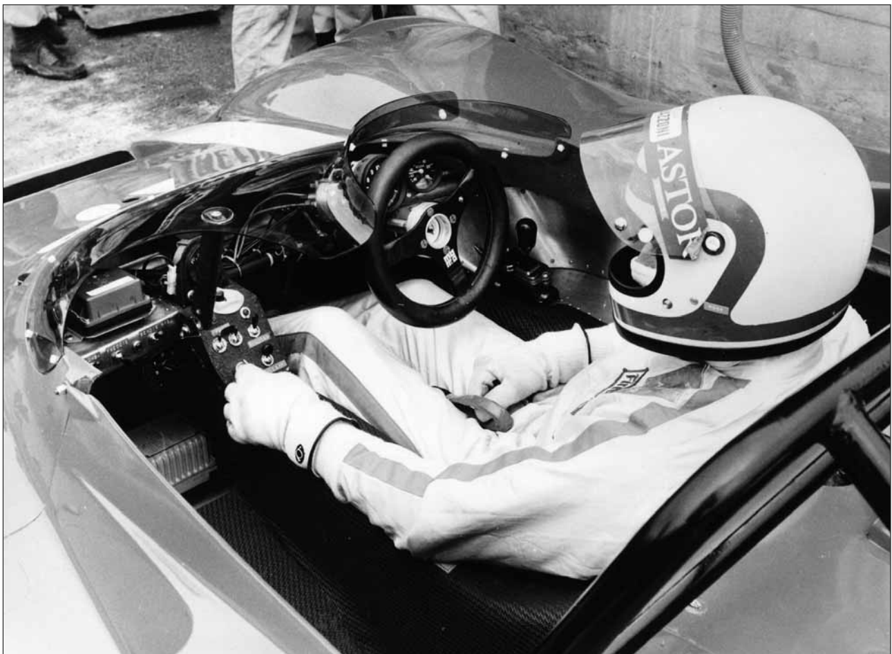
Le poste de pilotage de la Ferrari 312P (0882). Monza, 24 avril 1972. Remarquez l'accessibilité des commandes et la disposition rationnelle des composants électriques. Clay Regazzoni est au volant.
